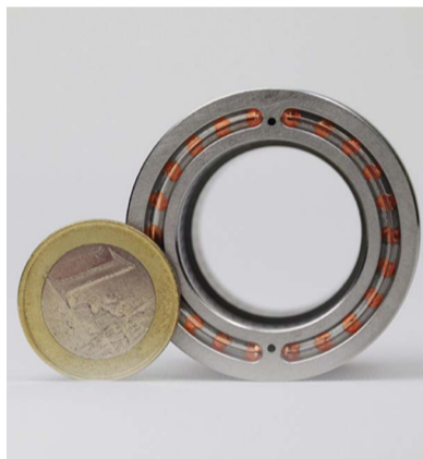
Formkernoberteil mit eingelöteten Kupferstiften (o.) und aufgetrennter Formeinsatz (u.)
