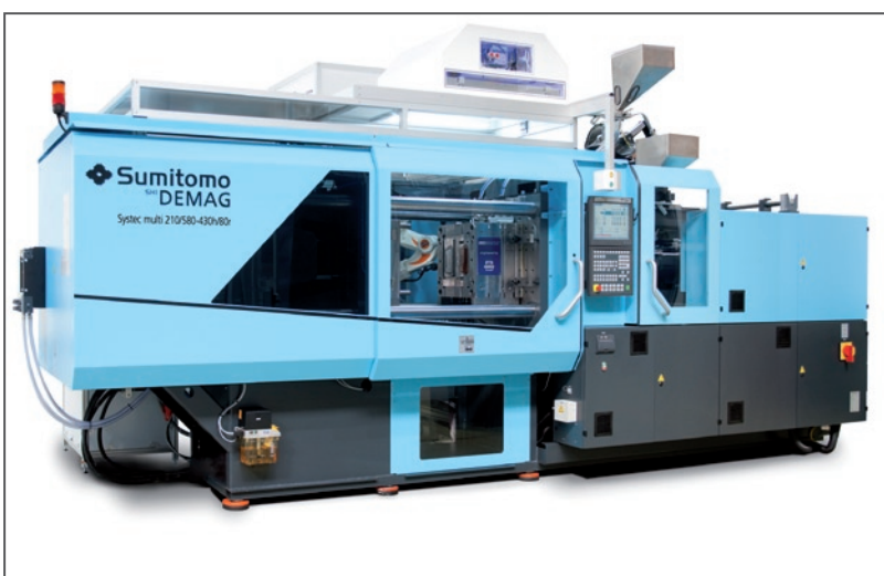
Die hydraulische Spritzgießmaschine Systec im Bild als Mehrkomponenten-Version Systec multi 210 mit 2.100 kN Schließkraft.
