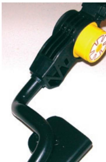
**Grat- und beschädigungsfreies Umspritzen eines KTL-beschichteten, mehrfach gebogenen Drahtes. Das Bild zeigt ein Pedal für den Audi A6. (Bild: Friedrichs + Rath, Extertal)**
