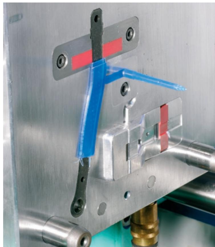
**Versuchswerkzeug zur Erprobung von A4200 (MurSeal®). (Bild: Kunststoff-Institut Lüdenschied)**
